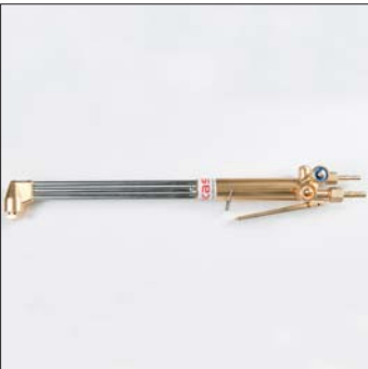
1600 P Oksijen - Propan Kesme Kapasitesi: 0-300 mm Boy: 500 mm Kafa Açısı: 90°
