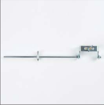
1101 Pergel ve Kesici Arabası Düz ve daire kesim işlemlerinde kullanılır. Nokta pergeliyle 80 mm - 800 mm ölçülerinde daire kesimi yapılır.
