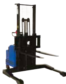
Geniş Ayaklı Tam Akülü İstif Makinesi ATFL 15B16M Taşıma Kapasitesi: 1.5 ton Kaldırma Yüksekliği: 1600 mm
