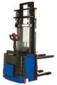
Tam Akülü İstif Makinesi ATFL 2030M Taşıma Kapasitesi: 2 ton Kaldırma Yüksekliği: 3000 mm
